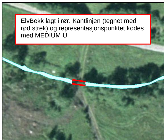
Figur 8: I en del elver kan det være stor variasjon i hvor elvekanten går avhengig av liten eller stor vannstand. Det presiseres at man skal prøve å registrere der høy vannføring i elva normalt går og ikke vannspeilet. Bruk KVALITET til å angi usikkerheten i registreringen. I bildet over er det tegnet inn med blå strek hvor man antar at normal vannføring er.
